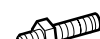
Perno de montaje (M5 x 20 mm) Bullone di montaggio (M5 x 20 mm) Monteringsbult (M5 x 20 mm) Kiinnityspultti (M5 x 20 mm)
